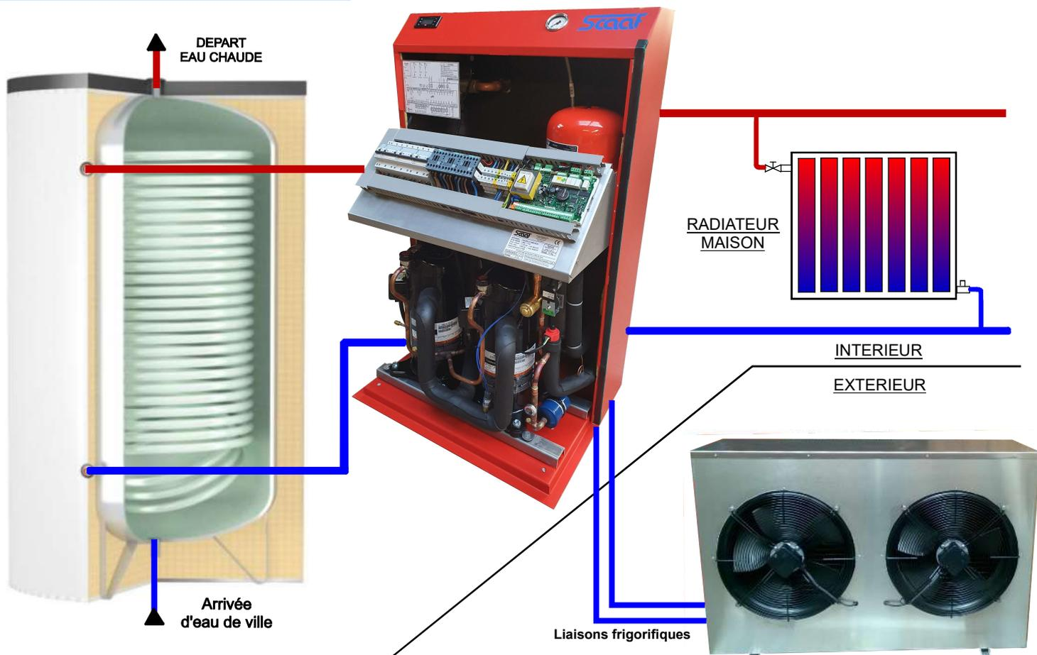
Pour optimiser les performances de son appareil, il faudra régler au plus juste la température dans le circuit de chauffage, car plus la température du circuit de chauffage est élevée, plus le rendement diminue. Dans le cas d'un circuit radiateur, ou de l'eau à 45°C ne suffit pas, nous conseillons le remplacement d'un ou plusieurs radiateurs, afin d'optimiser le confort, les performances, et le bon fonctionnement de l'appareil.
